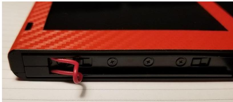
Posiziona il JIG in modo da collegare il primo e l'ultimo pin della rotaia del Joy-Con destro (nello Switch non sul Joy-Con).
