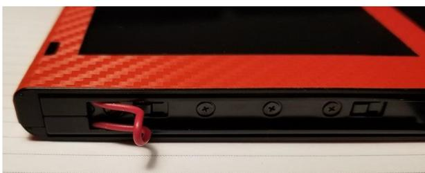
Placez le JIG dans le rail de droite de votre console et poussez vers le bas jusqu'à ce qu'il soit bloqué. Ensuite placez le dongle dans le port USB-C de votre console.
