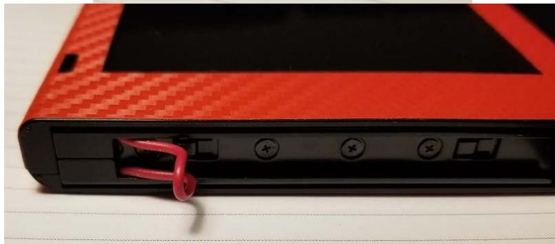
**Positioniere dein RCM Jig so, dass es den ersten und den letzten Pin der rechten Joy-Con-Schiene an der Switch überbrückt (nicht am Joy-Con selbst).**
