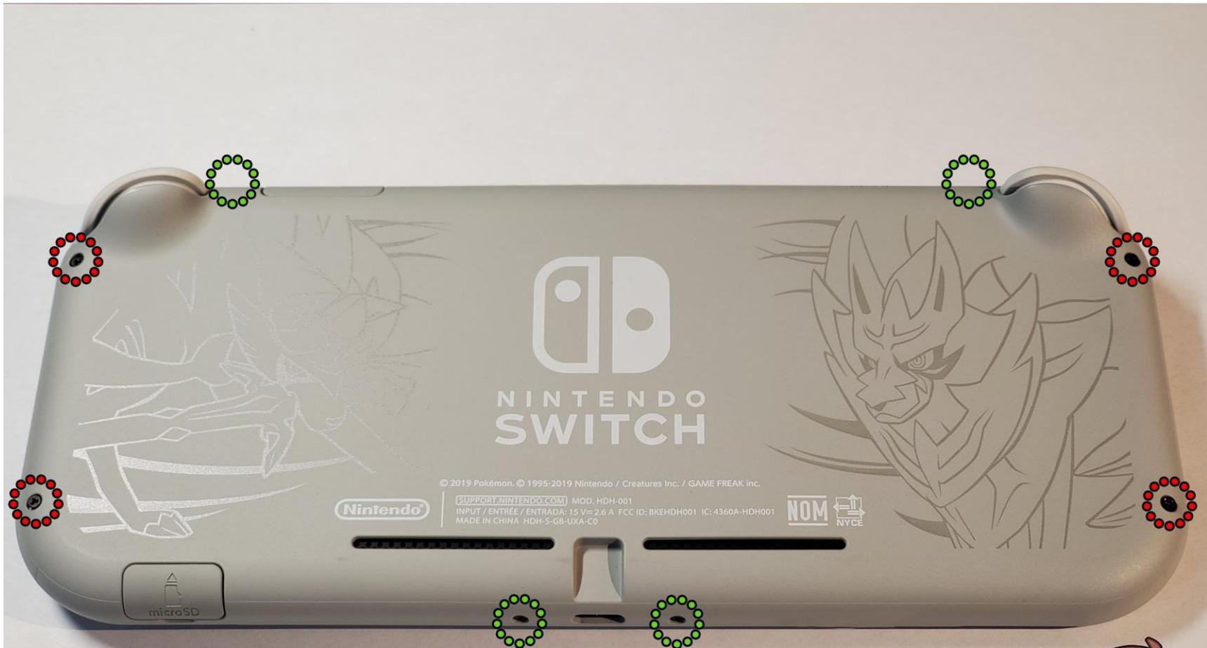
Započnite odvrtnjem **4 Tri-Wing**
