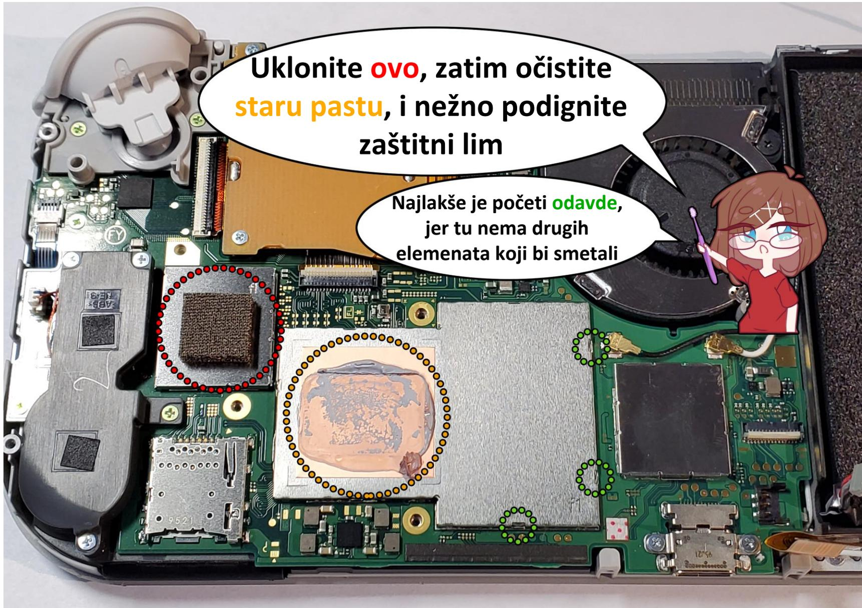
Uklonite **ovo**, zatim očistite **staru pastu**, i nežno podignite zaštitni lim
