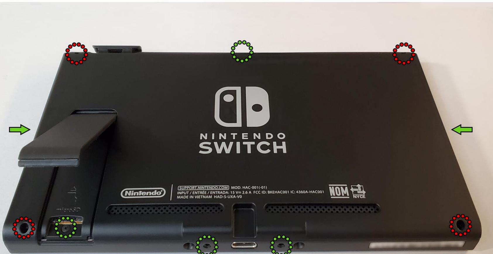
Započnite odvrtanjem **4 Tri-Wing**
