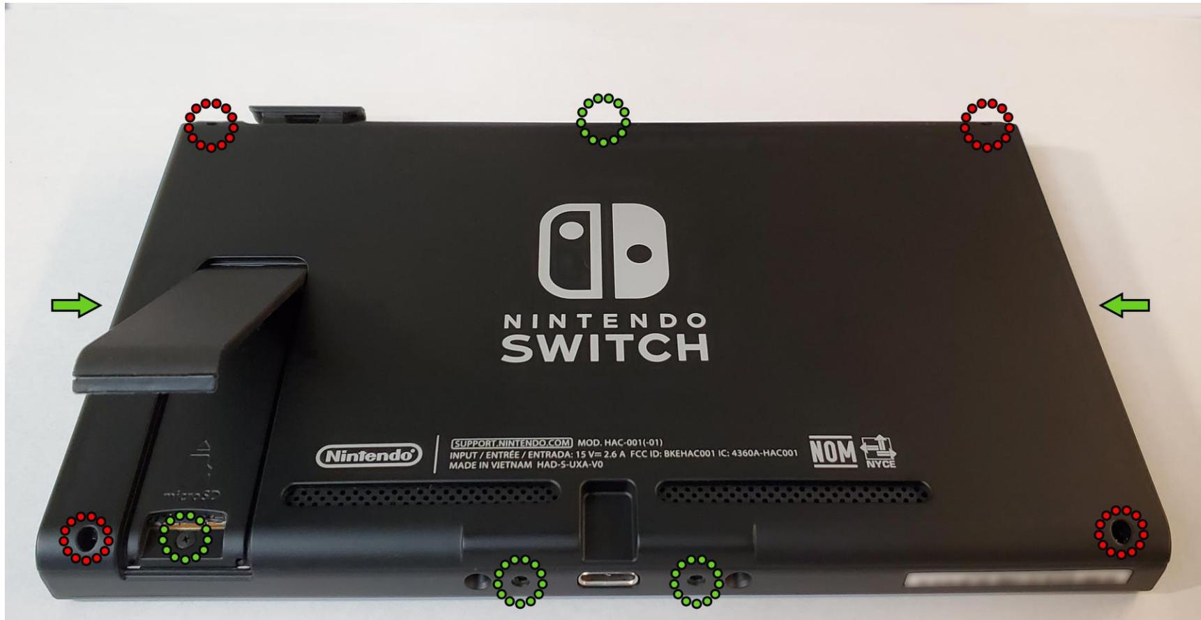
最初はネジを外していこう! **4つのY字型ネジ**と**6つの[+]ネジ**を外そう。ゲームカードとMicroSDを抜くのも忘れずに!
