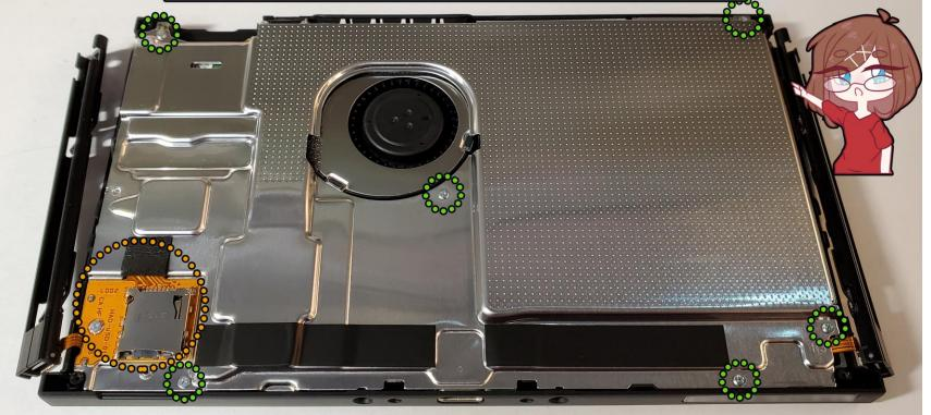
THE SD READER NEEDS TO BE DISCONNECTED FROM UNDER THE FOAM BLOCK. LOOK OUT FOR THE THERMAL PUTTY UNDER THE SHIELD!
