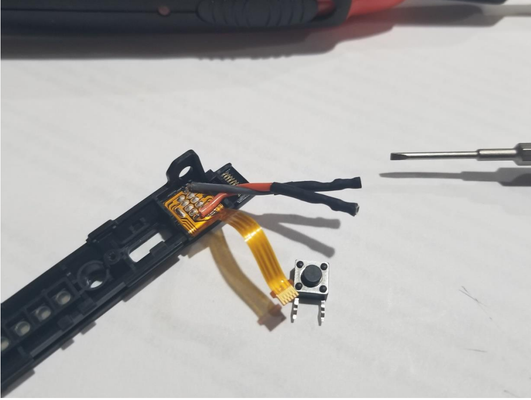
(Görsel 22 - Jumper Kablolar JoyCon Kızak Konektörüne Lehimlenmiş Halde)
