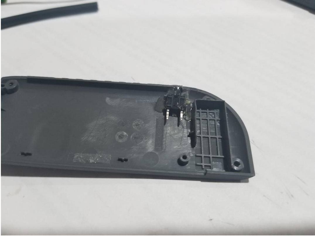
(Görsel 18 - Sıcak Silikonla Yapıştırılmış Geçici Anahtar)
