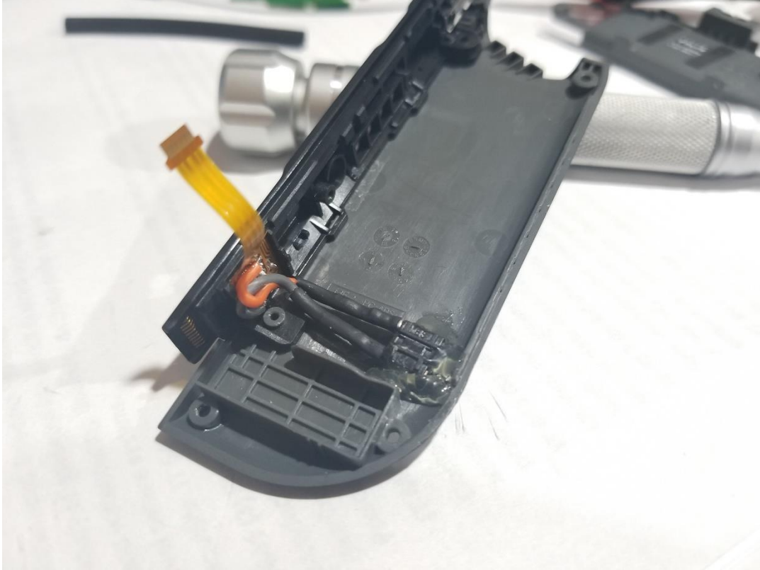
(Görsel 24 - JoyCon Kızak Konektörü Geçici Anahtara ve Arka Kapağa Bağlanmış Halde)
