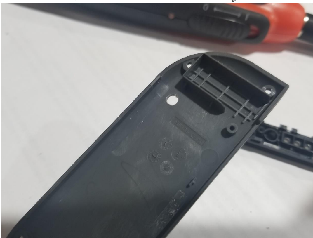
(ภาพที่ 17 - รูที่เจาะ (เหลื่อมไปทางซ้ายนิดหน่อย))
