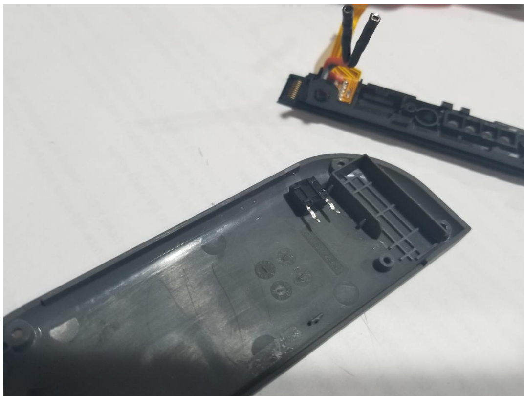
(ภาพที่ 16 - ใช้สวิตต์ในการหาตำแหน่งที่จะเจาะรู)
