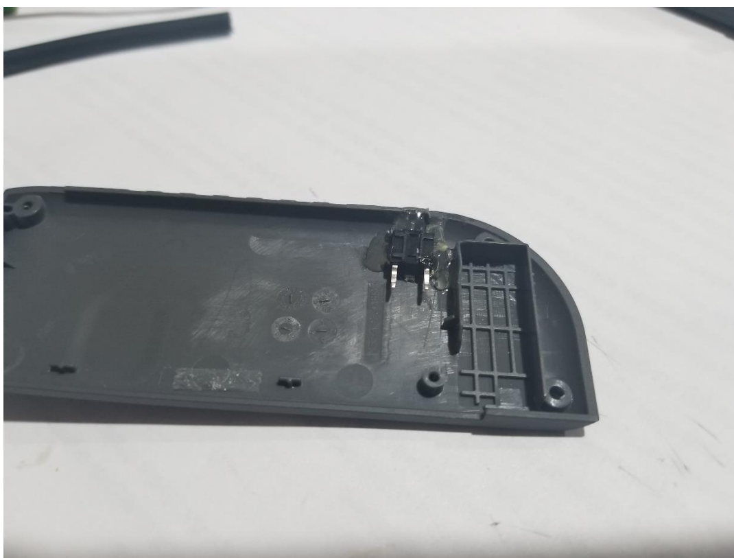
(ภาพที่ 18 - สวิตต์ที่ติดกับฝาหลังของ JoyCon)
