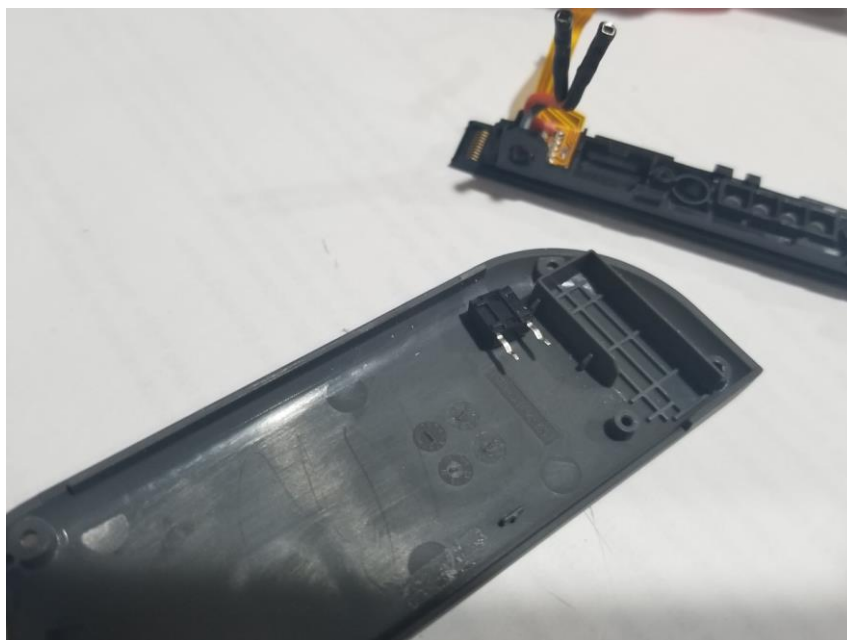
圖 16：利用按鈕找到合適的鑽孔位置
