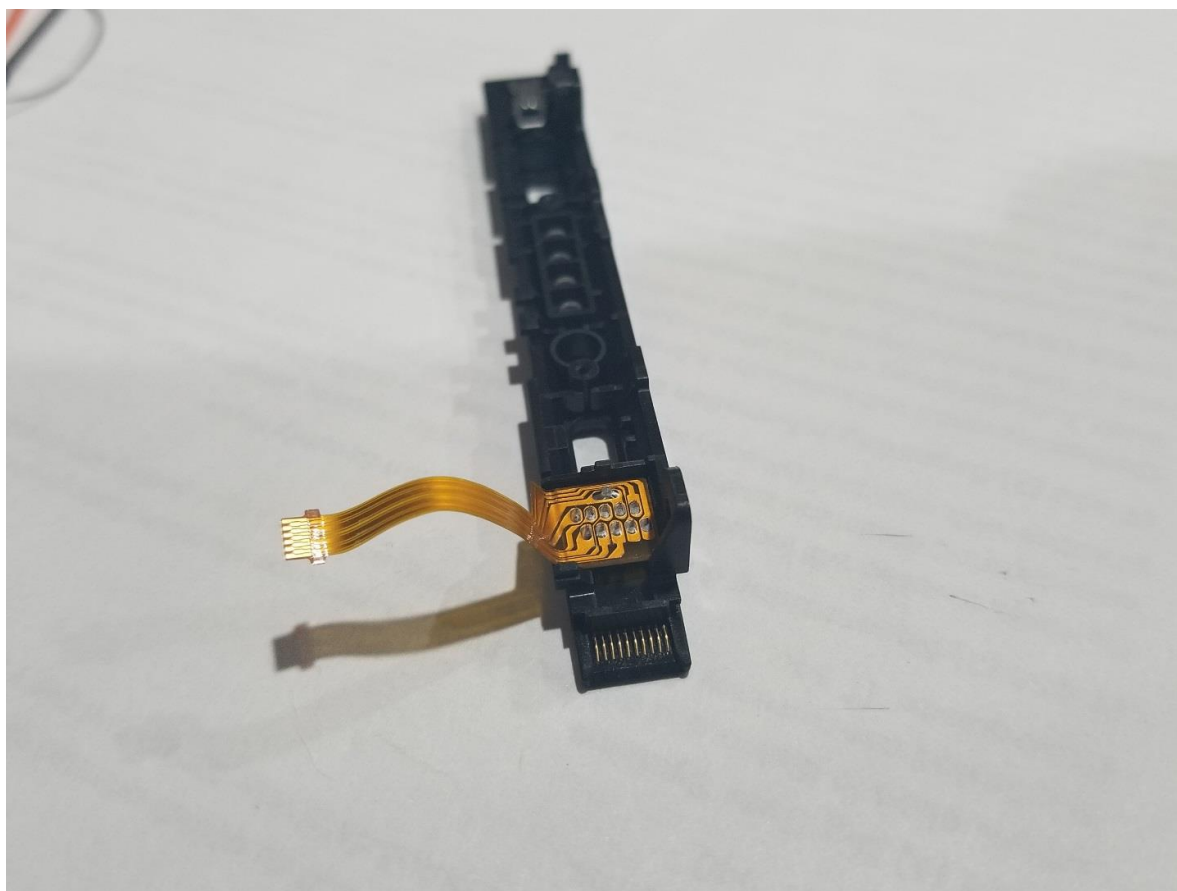
圖 15：Joycon 的滑軌連接板完全分離
