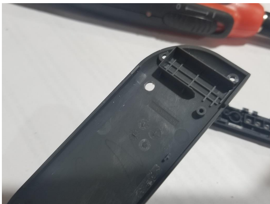
圖 17：已鑽孔的 Joycon 背側外殼（輕微過於偏左）
