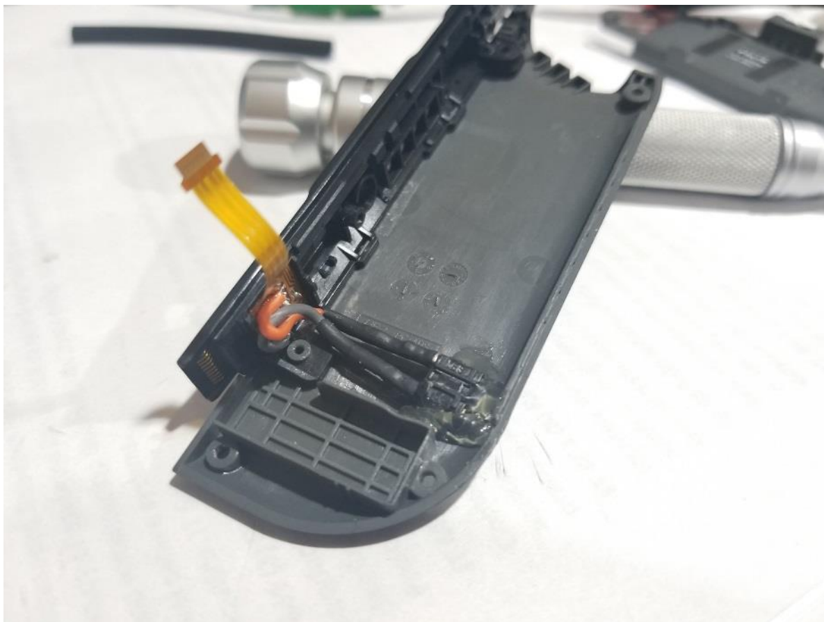
圖 24：Joycon 的滑軌電路板連接到按鍵式開關和 Joycon 背側外殼
