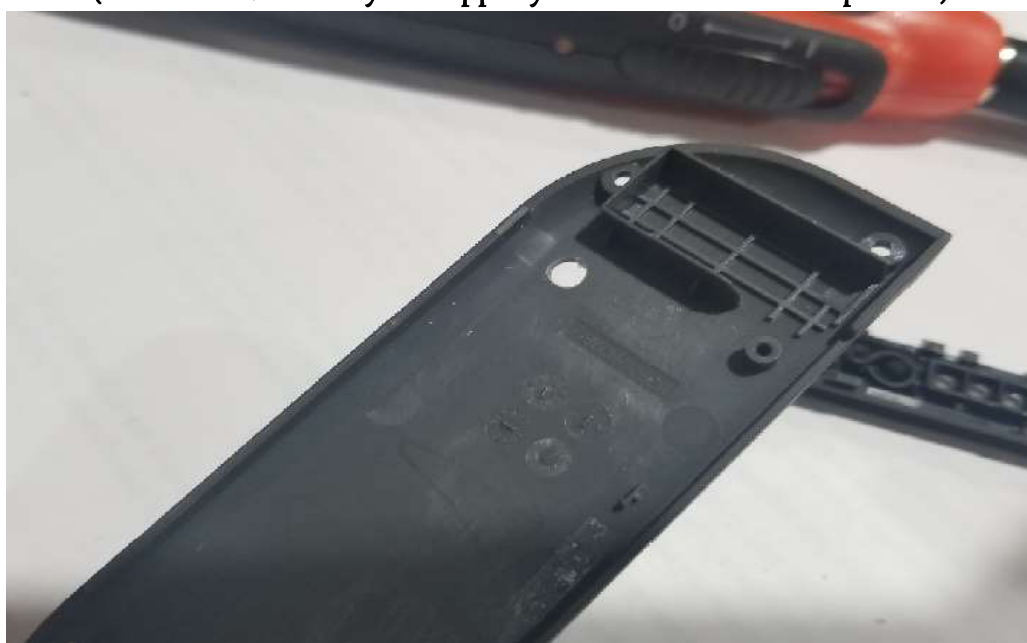
(Bild 17 - Hål borrat på baksidan av JoyConen (Lite för långt åt vänster))
