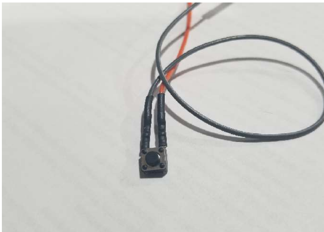
(Bild 13 - Tryckknapps brytare ansluten till Jumperkablar)
