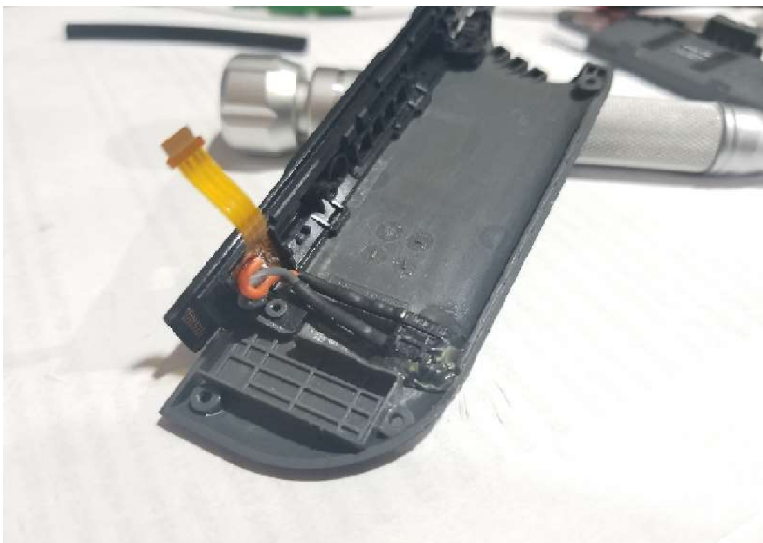
(Bild 24 - JoyConens Skjutanslutningskort ansluten till brytaren och JoyConens Baksida)
