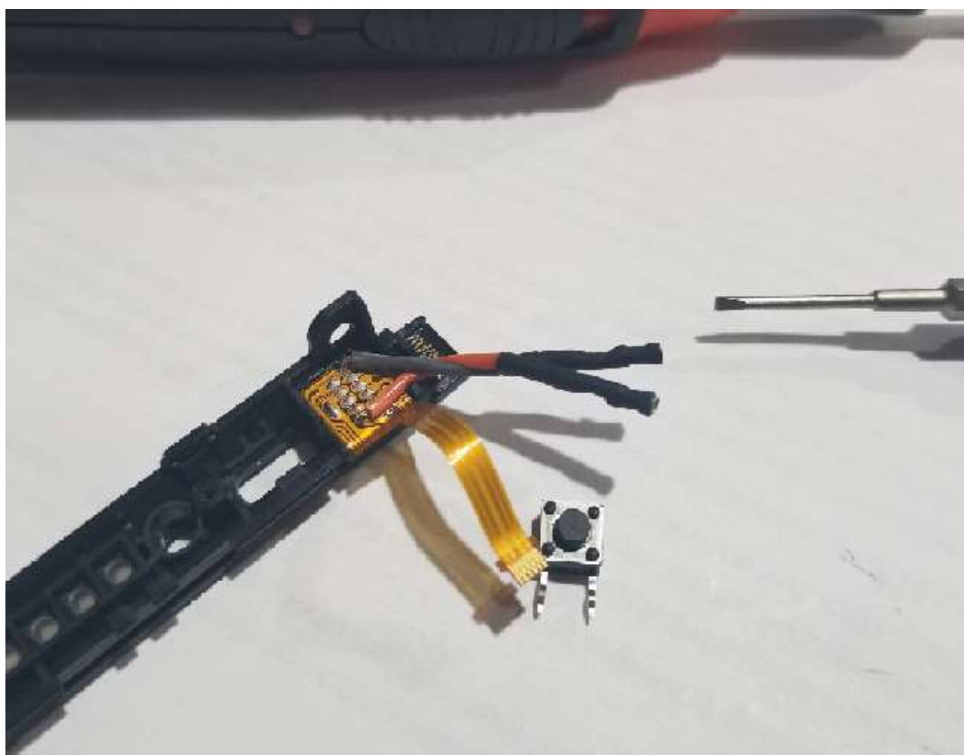
(Bild 23 - Jumperkablarna lödade till JoyConens Skjutanslutningskort)
