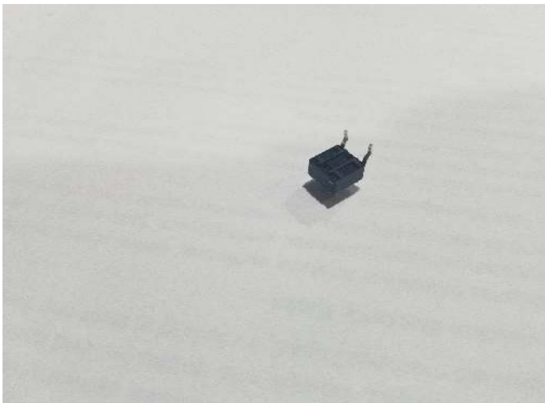
(Bild 11 - Tryckknapps brytare med Sidoben borttagna)
