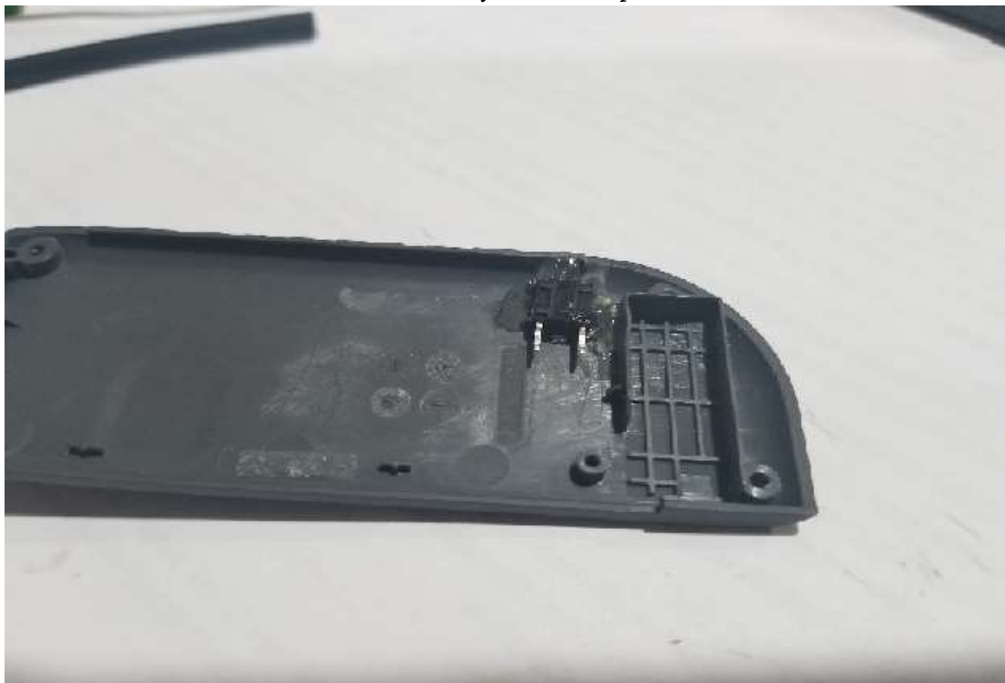
(Bild 18 - Brytaren säkrad på plats med lim)
