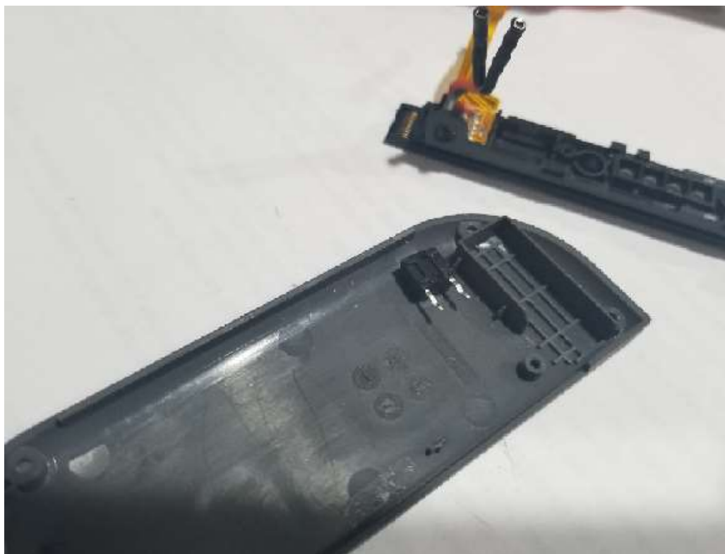
(Bild 16 - Använda Tryckknapp brytaren för att hitta Borrplatsen)
