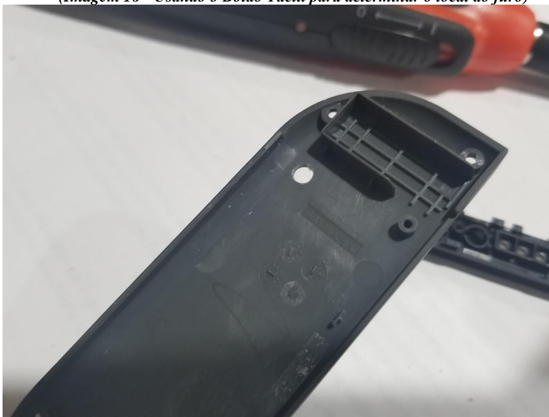
(Imagem 17 - Furo pronto na carcaça traseira do JoyCon (um pouco demais para a esquerda))
