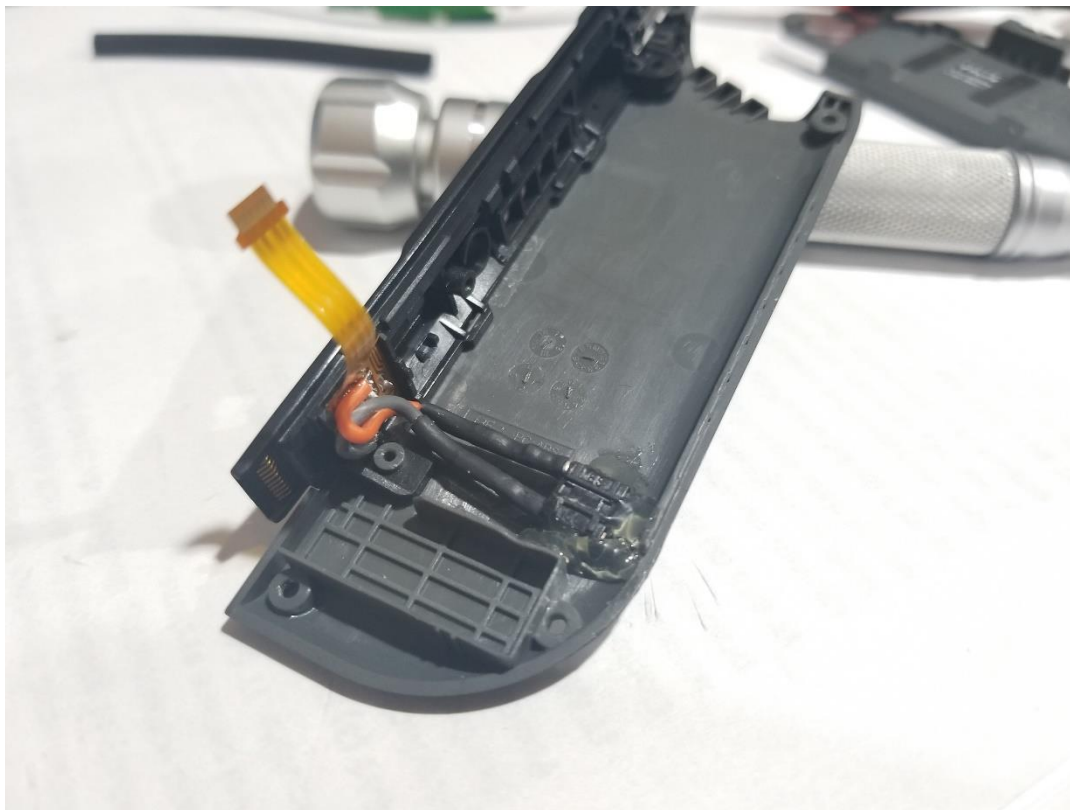
(Imagem 24 - Placa de conectores do trilho encaixada e conectada ao botão táctil)
