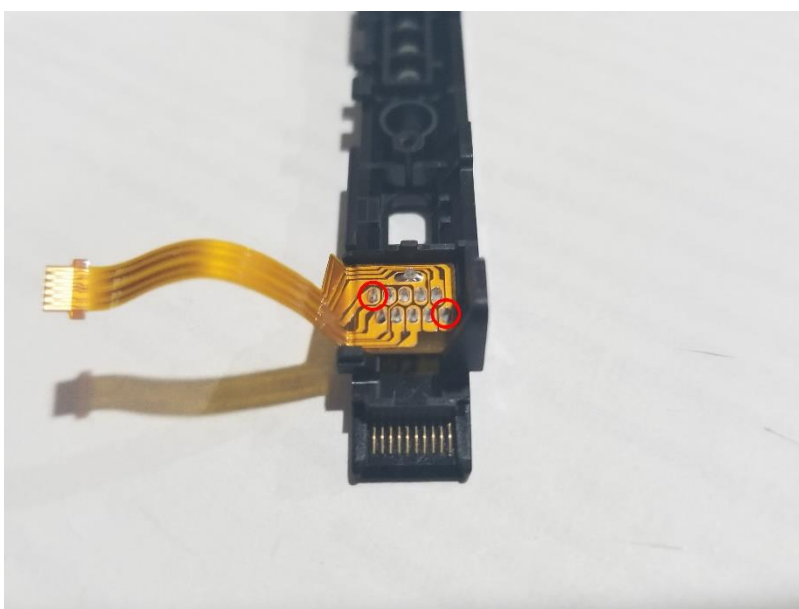
(Imagem 20 - Testando os pinos para encontrar os pontos de solda corretos)
