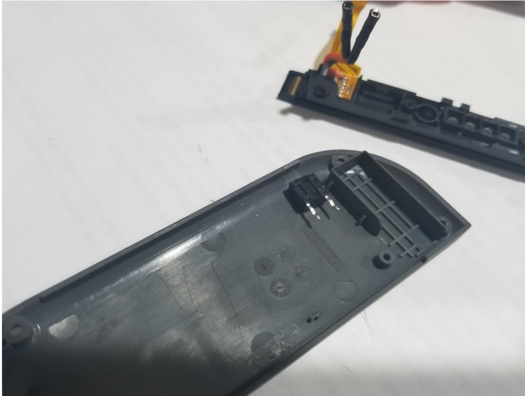
(تصویر شائزده: از خود مایکرو سویچ جهت یافتن جای مناسب برای سوراخ کردن استفاده کنید)
