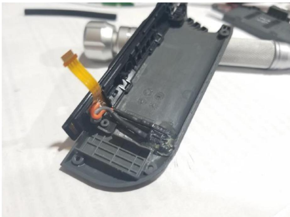
*(image 24 - Arrière du joy-con, rail, avec bouton et câbles connectés)*
