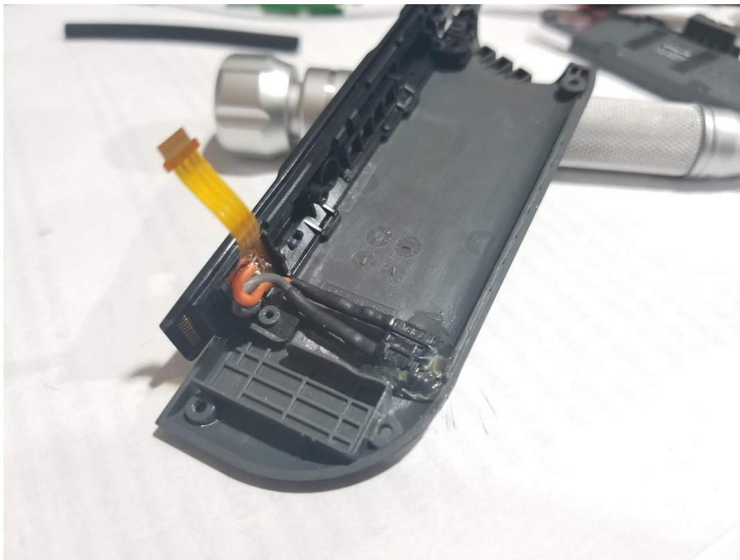
(Kuva 24 - Liukumekanismi paikallaan ja kytkin yhdistetty)
