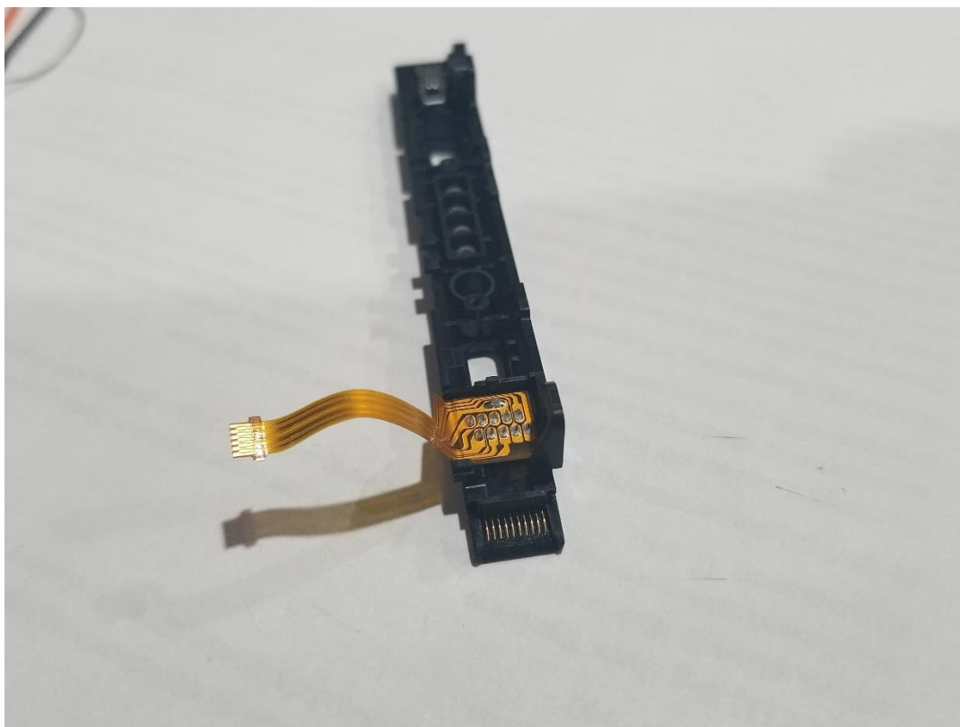
(Kuva 15 - JoyCon Liukumekanismi irti)
