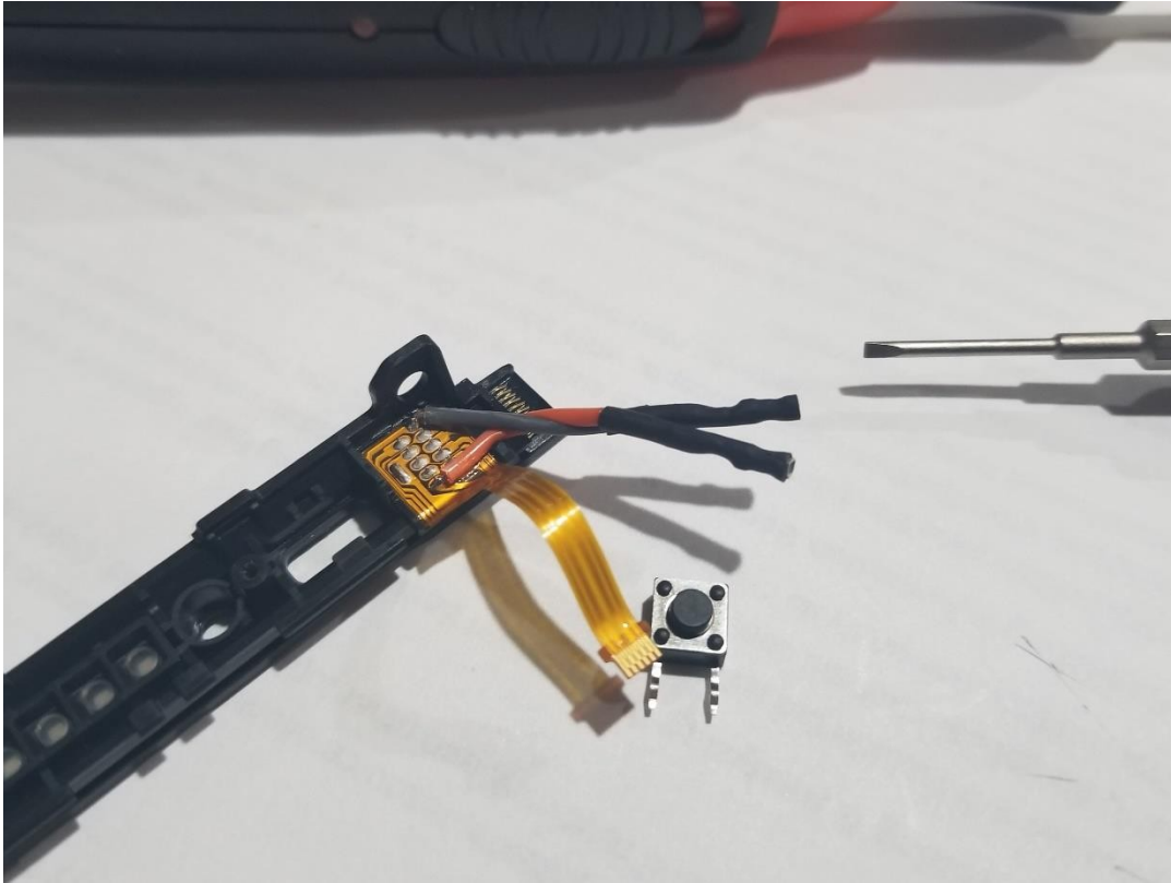
(Kuva 23 - Johtimet juotettuna)
