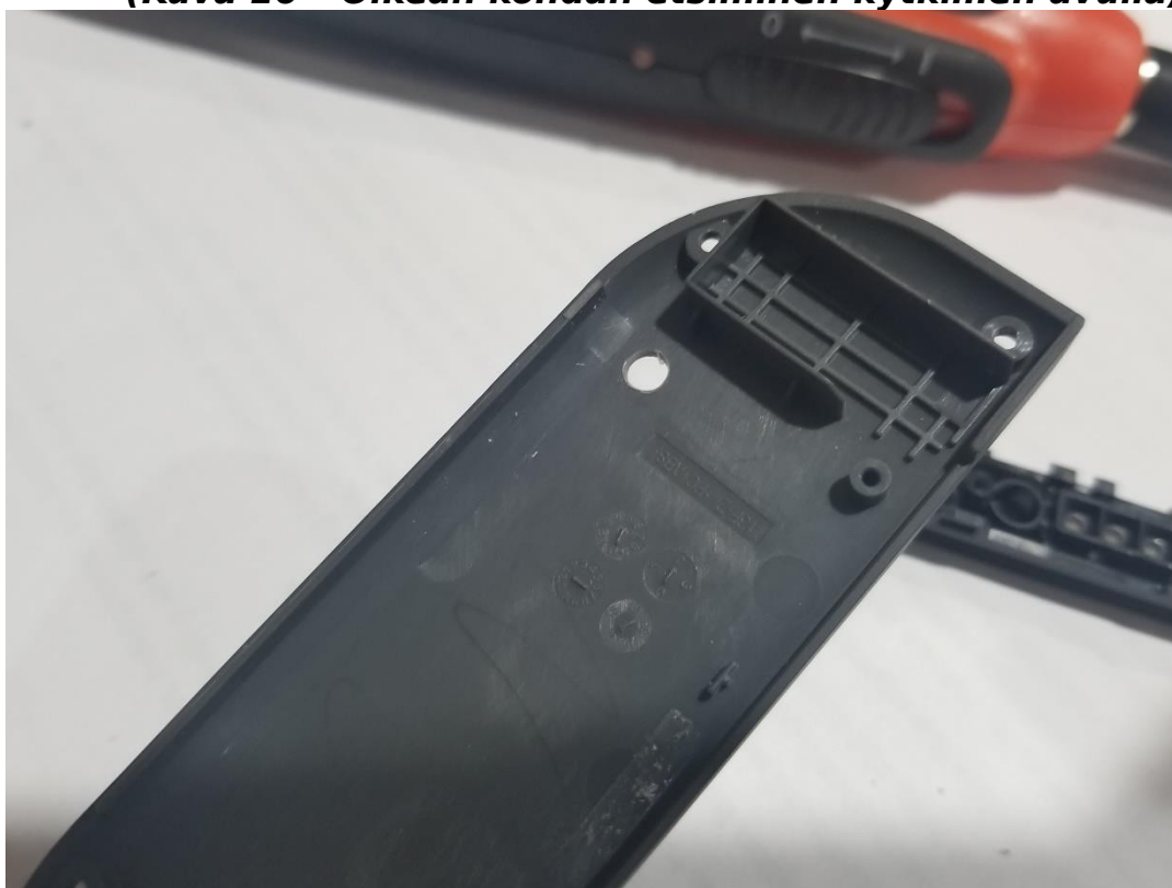
(Kuva 17 - Valmis porattu reikä)
