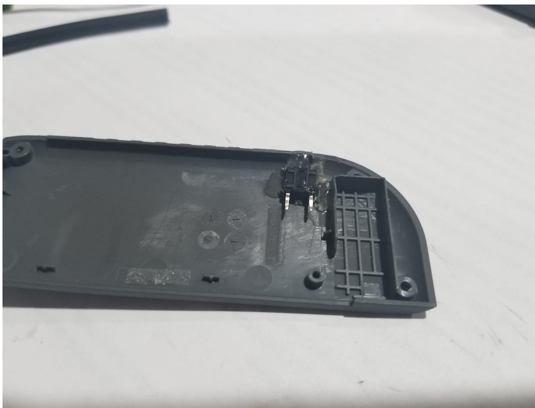
(Kuva 18 - Kytкин liimattuna paikalleen)
