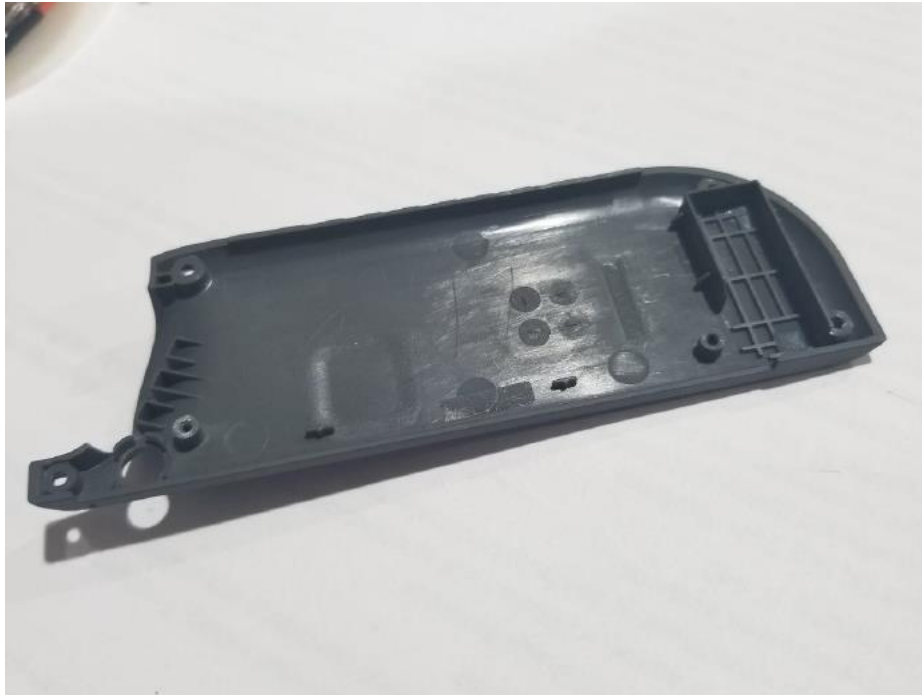
Abbildung 14 - Entfernte Rückseite des Joycons
