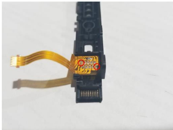
Abbildung 21 - Lötunkte für Pin 1 und Pin 10
