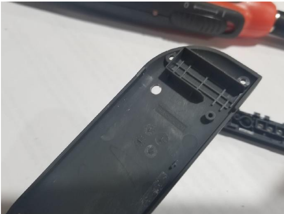
Abbildung 17 - Gebohrtes Loch (Hier ein wenig zu weit links)
