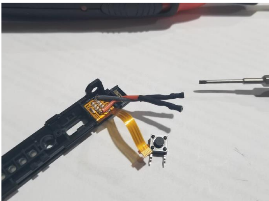
Abbildung 23 - Fertige verlötung der Kabel
