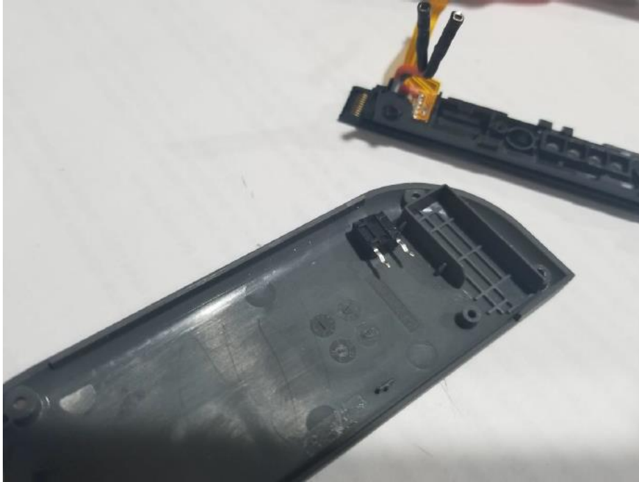
Abbildung 16 - Den Taster nutzen um die Bohrstelle zu finden
