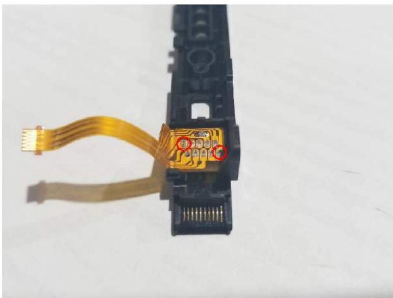
(图 21 - 红圈为应该焊接的第一针脚与第十针脚)
