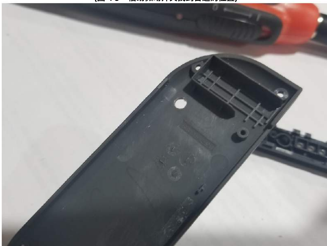
(图 17 - Joycon 背板上开的洞 (有点太靠左了))
